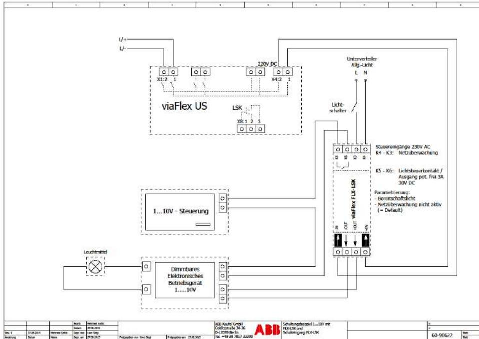
Bild 3 Schaltungsbeispiel 1...10V mit FLX-LSK und Schalteingang FLX-LSK
