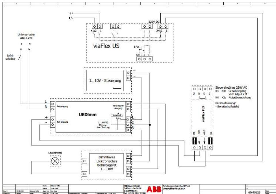
Bild 7 Schaltungsbeispiel 1...10V mit Umschaltweiche UE-DIM
