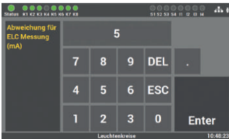
Abb. 90: Maske „Schwellwerte“ (Einzelleuchtenüberwachung)
