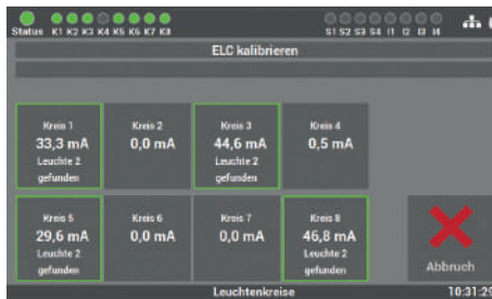
Abb. 83: Maske „Leuchten suchen“ (Einzelleuchtenüberwachung)
