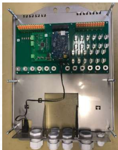
Abb: Combiner Box außen, innen und auf Batteriestack montiert
