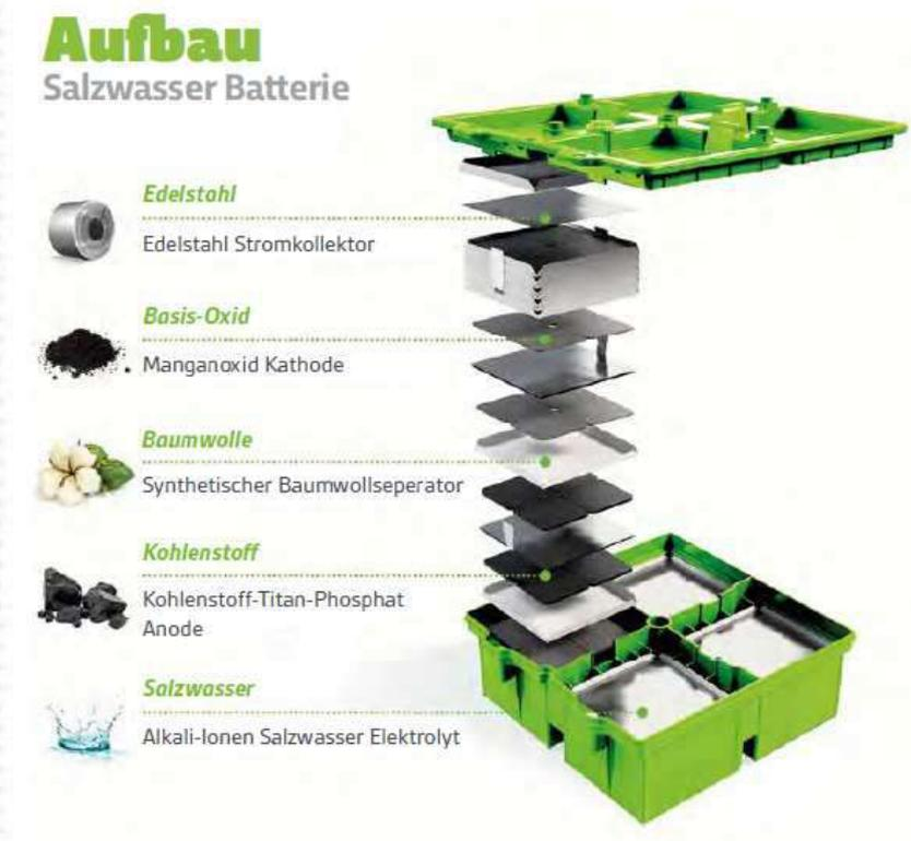
Zwischen der Anode aus Kohlenstoff-Titan-Phosphat und der Kathode aus Manganoxid wandern die Ionen aus dem Salzwasser Elektrolyt und machen den Energiefluss möglich. Durch den Wechsel der Ionen zwischen Anode und Kathode wird die Batterie be- und entladen. Es werden ausschließlich Materialien mit ausreichend Ressourcen verwendet, absolut ungiftige, häufig vorkommende Rohstoffe.
